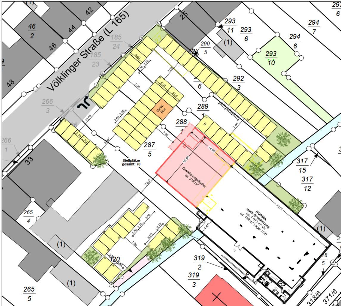
Abbildung 3: Lageplan Variante „Erweiterung Bestandsmarkt“ (Quelle: NORMA, eigene Ergänzungen)
