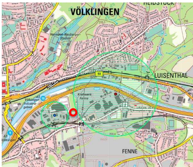
Abb: Störfallbetriebe mit Achtungsabstand, Quelle: Stadt Völklingen
