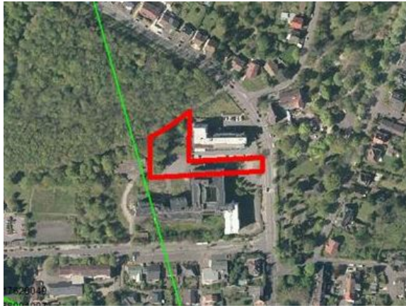
Abb.: Verlauf Richtfunkstrecke Telefonica, Quelle: Telefonica
